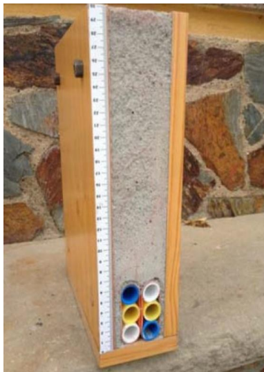
secció de microrasa de 6 conductes Ø20mm amb reblert de morter
